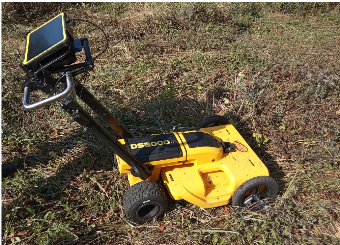
Ryc. 5. Georadar DS2000 podczas pomiarów przy Pałacu w Skrzynce.
