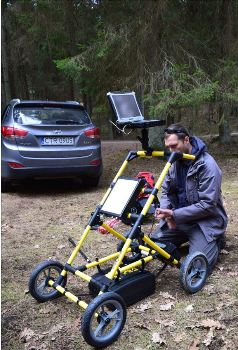
Ryc. 4. Autor podczas uzbrajania systemu U-Explorer do pomiarów w terenie (projekt Krasne).
